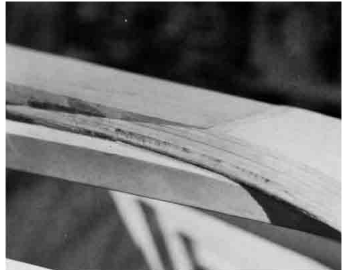
Bild 16.4 -Der lamellierte Kiel aus Esche ist an den massiven Mahagoni-Kiel angeschäftet.
