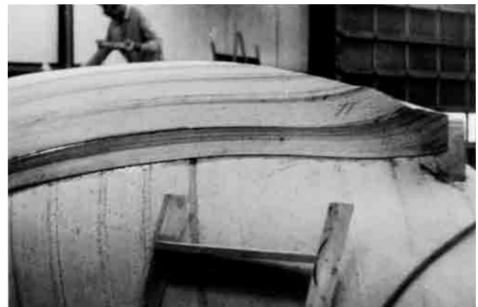
Bild 19.5 – Um dünne Furniere in negativ oder konkav gebogenen Bereichen in der Nähe des Skegs anzudrücken, sind mehr Klammern nötig. Beachten Sie auch das einigermaßen regelmäßige Klammernmuster auf der Beplankung im Vordergrund.
