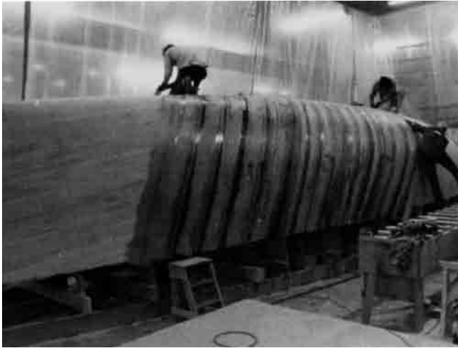
Bild 20.6 – Lamellieren der ersten Furnierschicht über die gestrakten Leisten. Beachte die Plankungsbank rechts.
