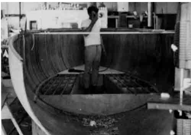
Bild 24.6 – Offen gelassener Spiegel erleichtert den Zugang zum Innenraum. In die Konstruktion integrierte Bänke sind zusätzlich als luftdichte Auftriebskörper dieser leichten Sloop konzipiert.
