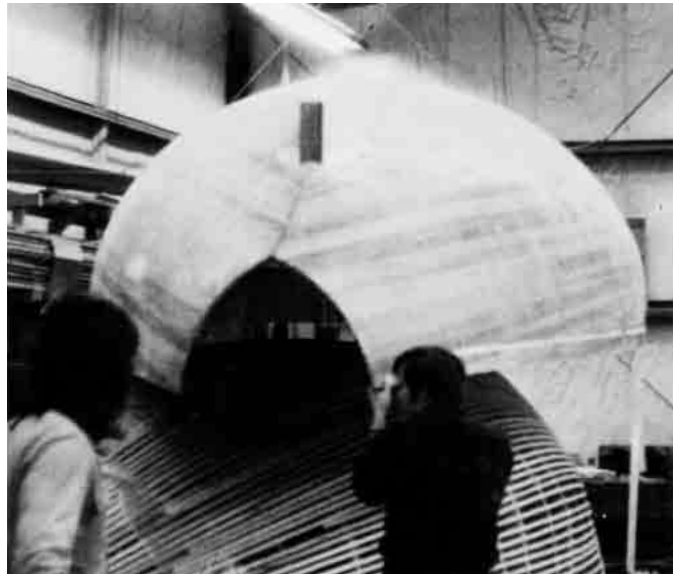
Bild 19.24 – Formverleimter Rumpf, der soeben von einem Leistenkern gehoben wird. Plastik-Schutzfolie ist am Heck des Blocks zu erkennen.
