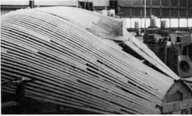
Bild 18.4 – Leistenblock für einen IOR Halbtonner. Beachten Sie die Verwendung kürzerer Leisten zum Auffüllen der Lücken zwischen den Leisten voller Länge. Der gezeigte Skeg wurde zunächst aus Furnier lamelliert und dann an dem Block provisorisch befestigt. Das Furnier, mit dem der Rumpf beplankt wurde, wurde mit dem Skeg verklebt. Dies wurde zur Ersparnis von zusätzlichen Kosten und Zeit für das Formen solch extremer Kurven während der allgemeinen Lamellierung vorgenommen.
