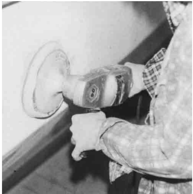
Bild 4.6 – Polierscheibe mit festem Schaumteller (Fabr. Black & Decker).
