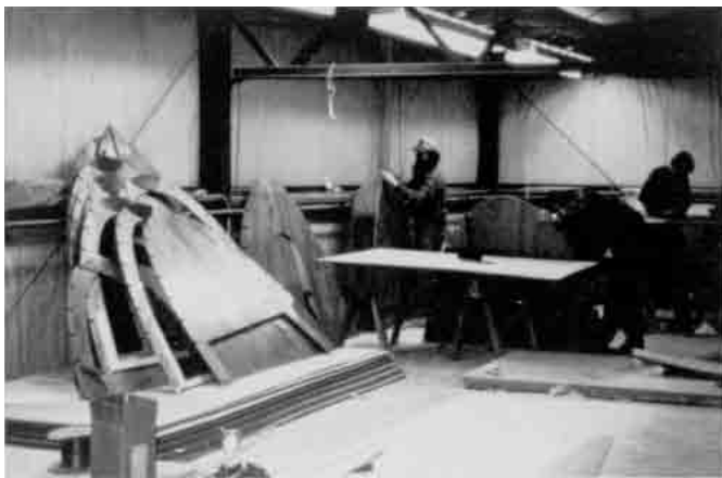
Bild 14.9 – Vorbeschichten von Rahmenspannten eines 18 m langen Trimarans.
