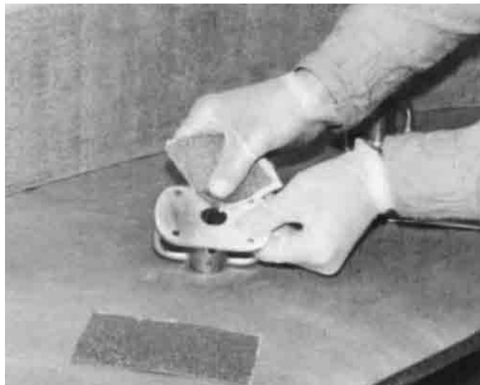
Bild 26.10 – Die Klebefläche wird mit grobem Schleifpapier angeschliffen.
