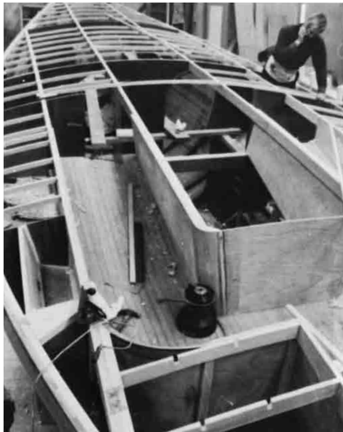
Bild 25.9 – Von Deckslängsbalken getragenes Cockpit.
