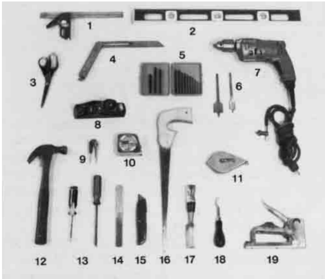
Bild 4.1 – Mindest-Werkzeug-Satz: (1) verstellbarer Anschlagwinkel; (2) Wasserwaage; (3) Schere; (4) Schmiegenstock; (5) Bohrerersatz; (6) Zentrumsbohrer; (7) Elektrische Bohrmaschine; (8) Putzhobel; (9) Zirkel; (10) Maßband; (11) Anreißschnur; (12) Latthammer; (13) Schraubenzieher; (14) Raspel; (15) Teppichmesser; (16) Holzstichsäge; (17) Stecheisen; (18) Krampenzieher; (19) Klammer-Pistole.
