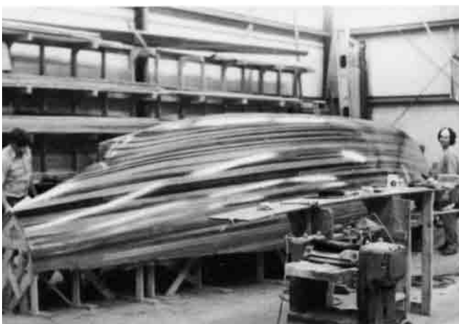
Bild 11.1 – Beschichten der Außenhaut einer Rennyacht der IOR Halbtonner-Klasse. Das Boot wird naturlackiert. Das Abstraken, Schleifen und Beschichten wurden vorgenommen, bevor das Boot vom Block abgehoben wurde.
