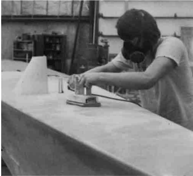
Bild 11.5 – Abschließender Schliff der grauen Harzbeschichtung auf dem Deck der SLINGSHOT. Orbitalschleifer eignen sich am besten für diese Arbeit.
