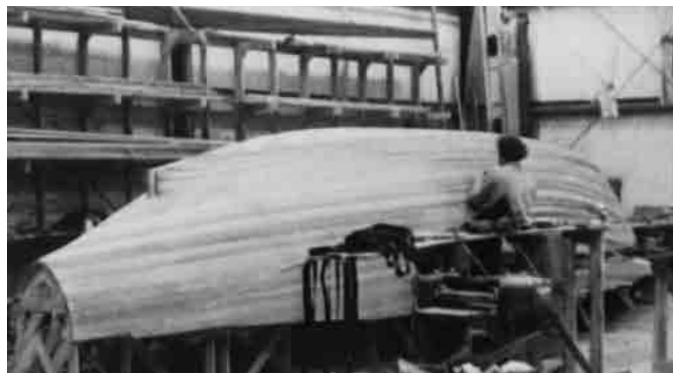
Bild 19.22 – Abschließende längs verlegte Furnierschicht auf einem Halbtonner.
