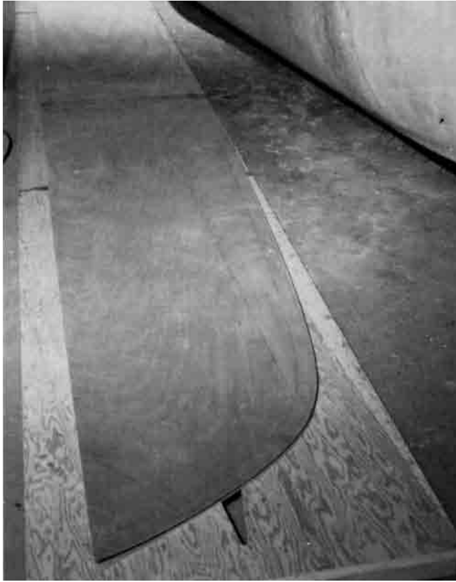
Bild 23.2 – Sperrholz-Rumpfpfplatten für einen Tornado Kataran. Diese Platten wurden aus 5 mm-Okoume-Sperrholz zugeschnitten.
