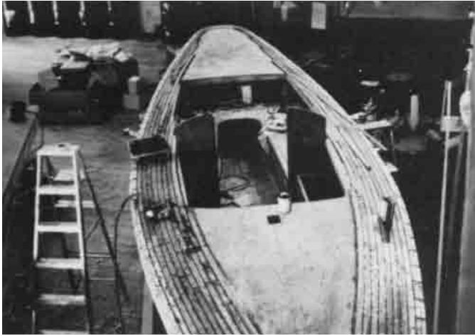
Bild 25.31 – Verlegen von Teakleisten parallel zur Seite Deck, angefangen entlang der Außenkante Deck, zur Decksmittle fortschreitend. Dieses Deck hat positiven Sprung.
