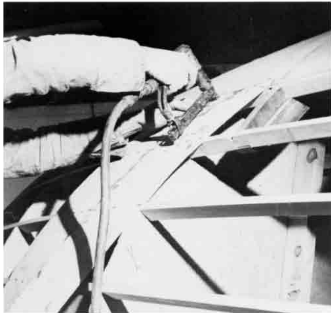
Bild 21.14 – Klammern der ersten Plankenschicht an die Seiten. Man beachte den lamellierten Spant und die Auffütterung oben rechts, sowie die Wasserlaufböcher (Nüstergatten) in den Stringern nahe der Auffütterung.
