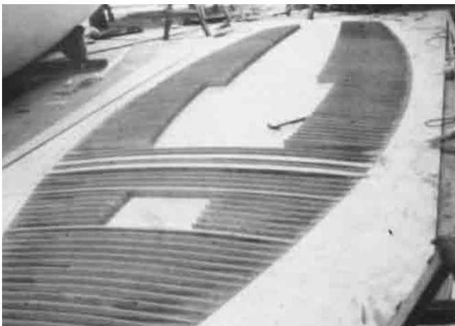
Bild 25.21 – Reststreifen von Sperrholz werden hier für das Rahmenwerk des Kerns eines Sandwich-Decks benutzt.
