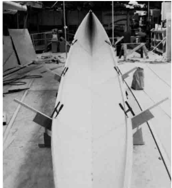
Bild 23.7 – An diesem Trimaran-Ausleger erkennt man provisorische Spantstützen.
