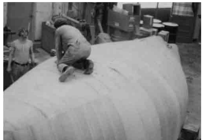
Bild 19.23 – Dieser Rumpf wird zur Vorbereitung auf die Harzbeschichtung abschließend geschliffen. Man beachte die Furniermaht entlang der Bilge. Die Seiten dieses Rumpfes bestehen aus ausgesuchten Furnieren, die von der Deckskante bis gerade unter die Wasserlinie reichen.
