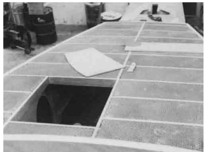
Bild 25.20 – Achterdeck der ROGUE WAVE mit 75 mm dickem Vertical-Kern zwischen Sperrholzplatten.
