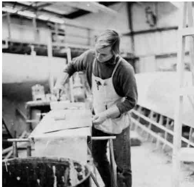
Bild 19.16 -Aufrollen einer dünnen Kleberrichtung auf eine Cedar-Furnierplatte mit einer Schaumrolle.
