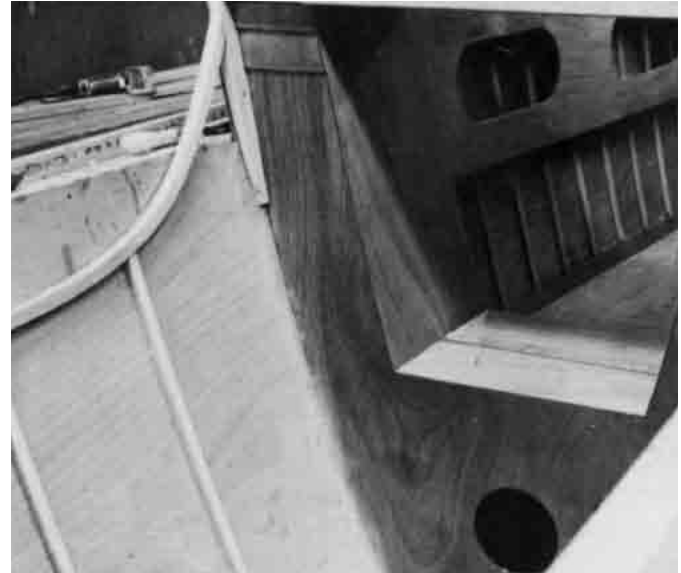
Bild 23.21 – Lamellierte Spanten, kastenförmiges Schott, Schwalbennester und Deckel der Sitzbänke, alle versteifen die verformte Sperrholz-Außenhaut bei diesem 10,70 m-Renntrimaran.
