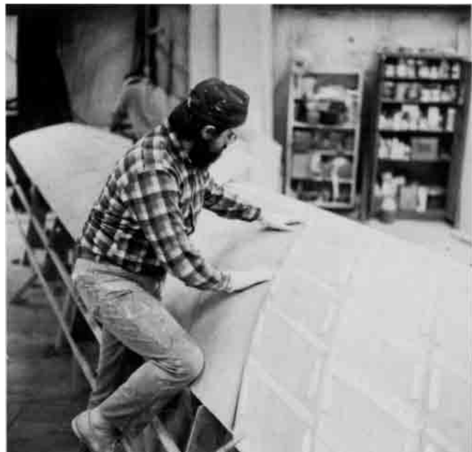
Bild 19.13 – Anpassen eines Furniers an eine vorher aufgeklebte Planke.
