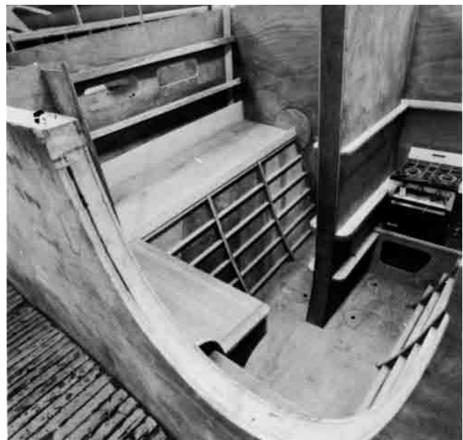
Bild 24.7 – Pantry, Lotsenkoje Navigationsecke und Schwerkasten der ROGUE WAVE. Die Inneneinrichtung war fertiggestellt, bevor das Deck aufgebracht wurde. Die kreisförmigen Brettchen auf dem Schott sind Verstärkungsdopplungen. Man beachte die herausnehmbaren Deckel im Fußboden. Unfertiger Teak-Plichtboden links unten.
