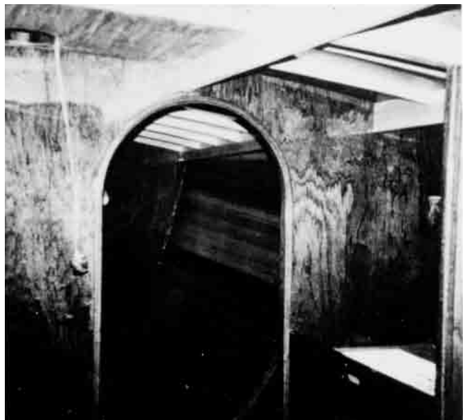
Bild 24.13 – Schott mit lamellierter Hartholzabdeckung im Durchgang.
