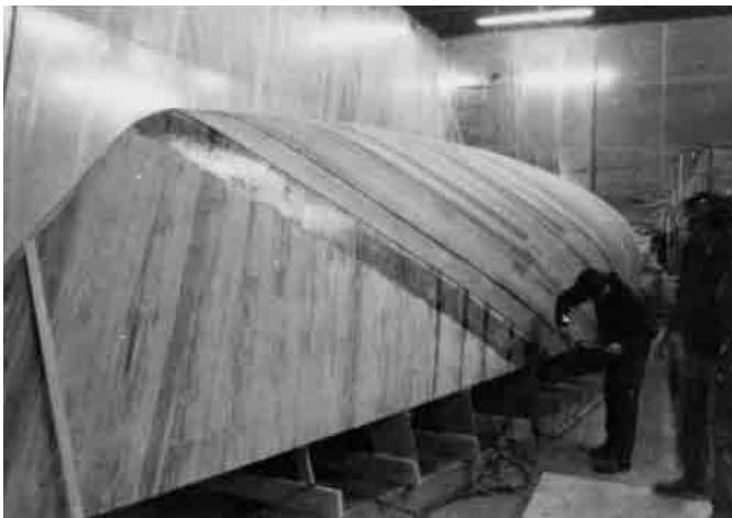
Bild 20.7 – Lamellieren der zweiten Furnierlage auf den Innenraum, in dem die Arbeit weitergehen kann, während die Rumpfung.
