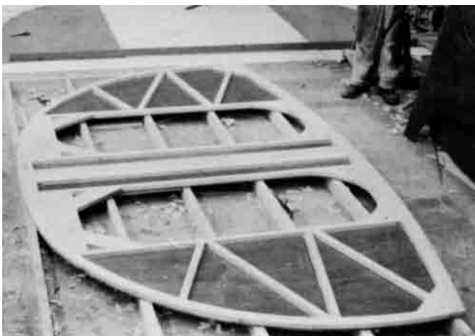
Bild 24.12 – Konstruktives Hauptschott von GOLDEN DAZY bestand aus einem Rahmenwerk zwischen zwei 12 mm dicken Gebrauchs-Sperrholzplatten.
