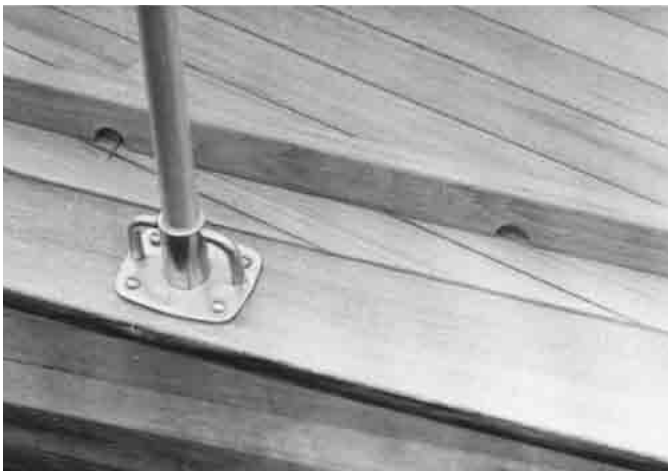
Bild 25.28 – Blick auf Teak-Deck, Mahagoni-Leibholz und Cedar-Außenhaut der GOLDEN DAZY. Alle drei Holzsorten sind nicht dicker als 4 mm und mit provisorischen Klammern verleimt. Man beachte die Teakholz-Fußbreling mit Wasserlauflochern.
