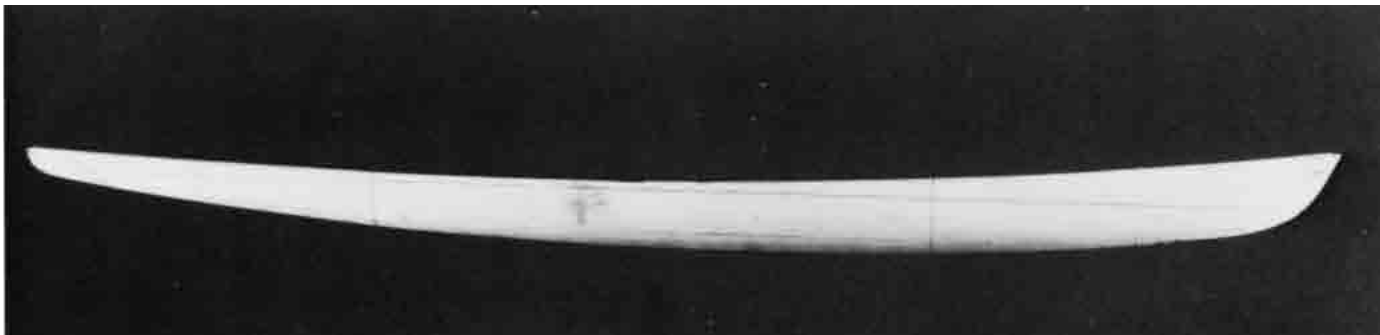
Bild 23.34 – Modell des in Bild 23.27 gezeigten Auslegerrumpfes. Bei diesem Modell sind Wasserlinien und Spantlinien angezeichnet.
