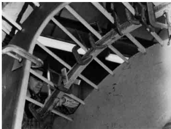
Bild 9.4 – Lamellieren von Bodenspannen, wobei die Stringer zur Formgebung benutzt werden.
