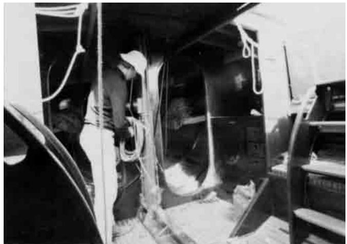
Bild 24.2 – Innenraum des in Bild 24.1 gezeigten Bootes. Man beachte den Teak-Fußboden mit Fugen aus einer weiß pigmentierten Harzmischung.
