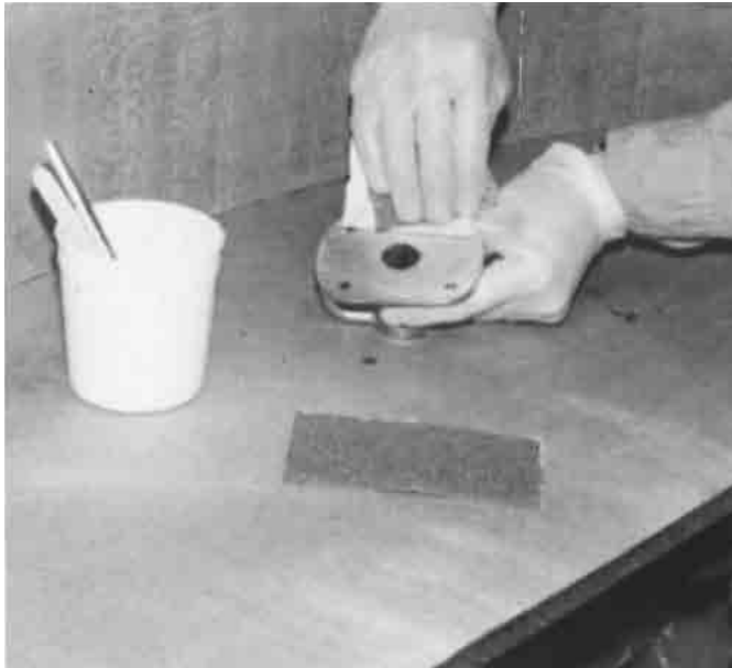
Bild 26.12 – Nasses Einschleifen von Harz in die Klebefläche.
