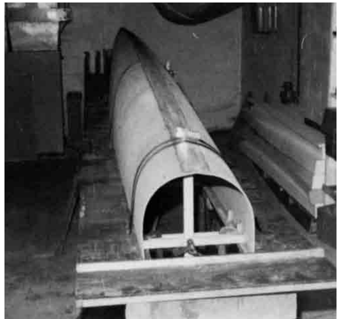
Bild 23.28 – Tornado-Katamaranrumpf, zusammengefaltet und in die Decks-Einspannvorrichtung gesteckt. Die Außenseite des Kiels ist gestrakt und mit Glasfasergewebeband beschichtet.
