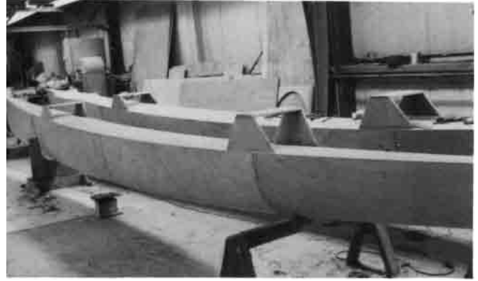
Bild 23.27 – Bau von 10,70 m-Trimaran-Auslegerrümpfen. Diese Rümpfe werden jetzt mit Epoxidharz und Glasfasergewebe beschichtet. (Siehe Kapitell und 12.)
