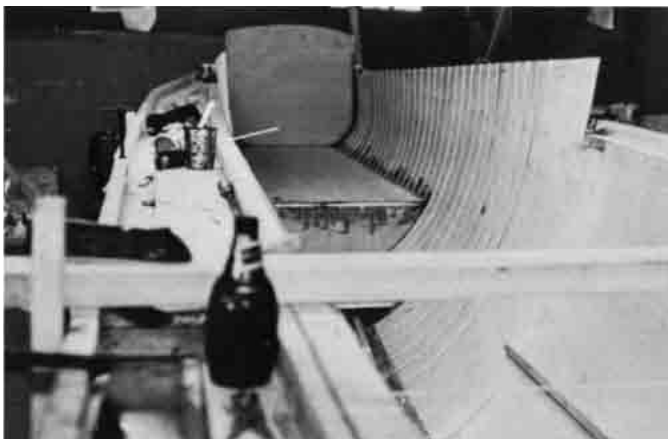
Bild 23.23 - Kobenboden und lameuierte Spanten zur Versteifung der Rumpf-Außenhaut.
