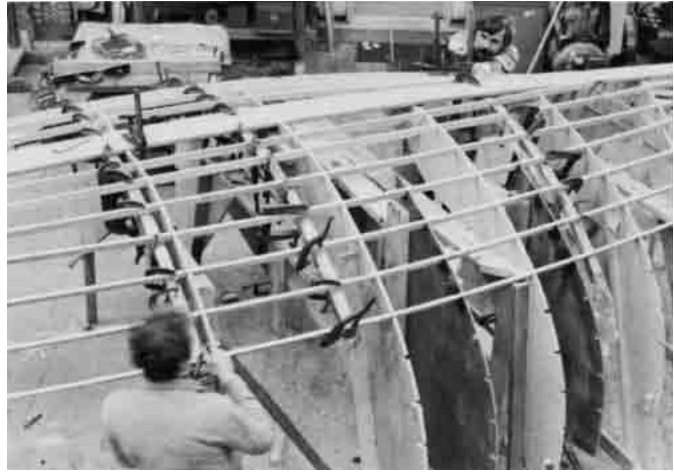
Bild 21.11 – Lamellierte Bodenwangen über Längsspanten. Um das Lamellieren und Einbauen der Bodenwangen zu vereinfachen, sind die Überwasserstringer noch nicht angebracht worden.
