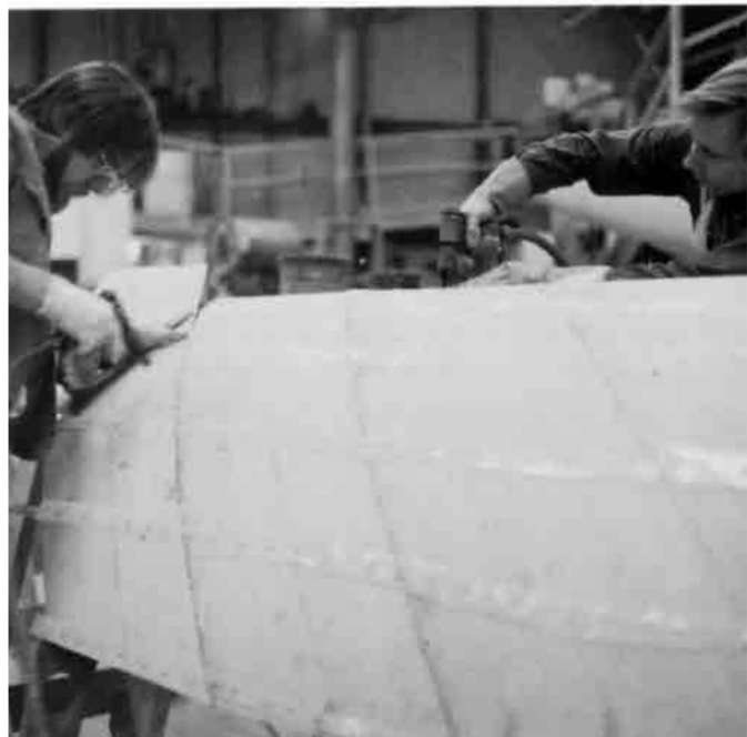
Bild 19.7 – Heften der Furnierplatten an die Rumpfstrenger. Man beachte die Verwendung von Plastikstreifen unter den Klammerköpfen, um das Entfernen zu vereinfachen.
