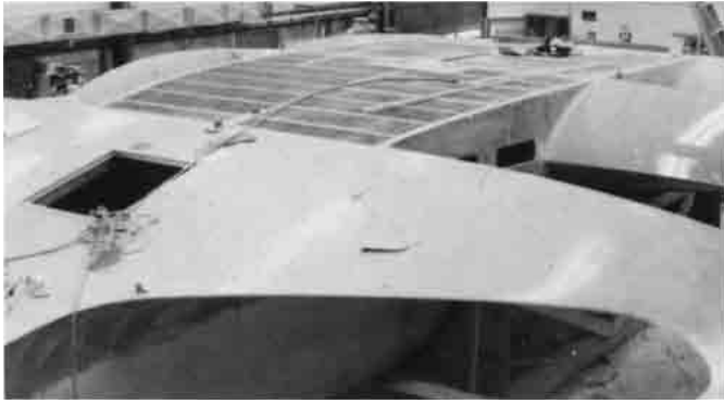
Bild 25.17 – Vordeck und Verkleidungen der Beams von ROGUE WAVE bestehen aus Sperrholz über Stringern. Das Deck über dem Kajütenbereich ist eine Sandwich-Konstruktion mit Vertical-Kern.
