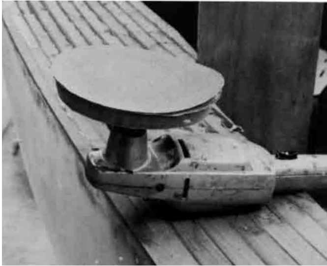
Bild 4.7 – Polier-Winkelschleifer mit Schaumteller. Wir befestigen auf dem Schleifteller ein 1,5 mm starkes Birkensperrholz. Die Oberfläche ist damit noch flexibel genug, um flachen Krümmungen zu folgen. Sehr gut für das Schleifen von Oberflächen unterschiedlicher Härte, wie WEST SYSTEM Harz und Spachtelmassen (Fabr. Black & Decker).
