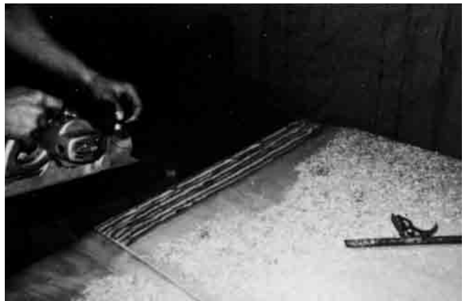
Bild 10.10 – Die Schäftung wird mit der Hobelmaschine geglättet.
