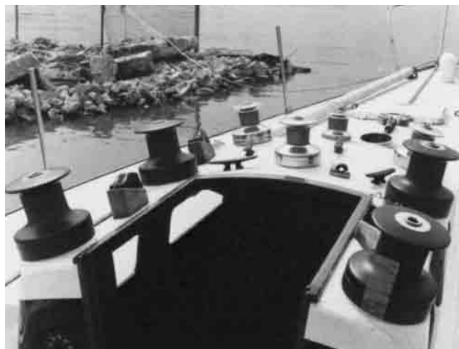
Bild 26.13 – Geklebte Beschläge auf Deck und Kajütdach der IOR-Halbtonner-Rennyacht HOT FLASH. Einige der Beschläge haben ein angegossenes Fundament.
