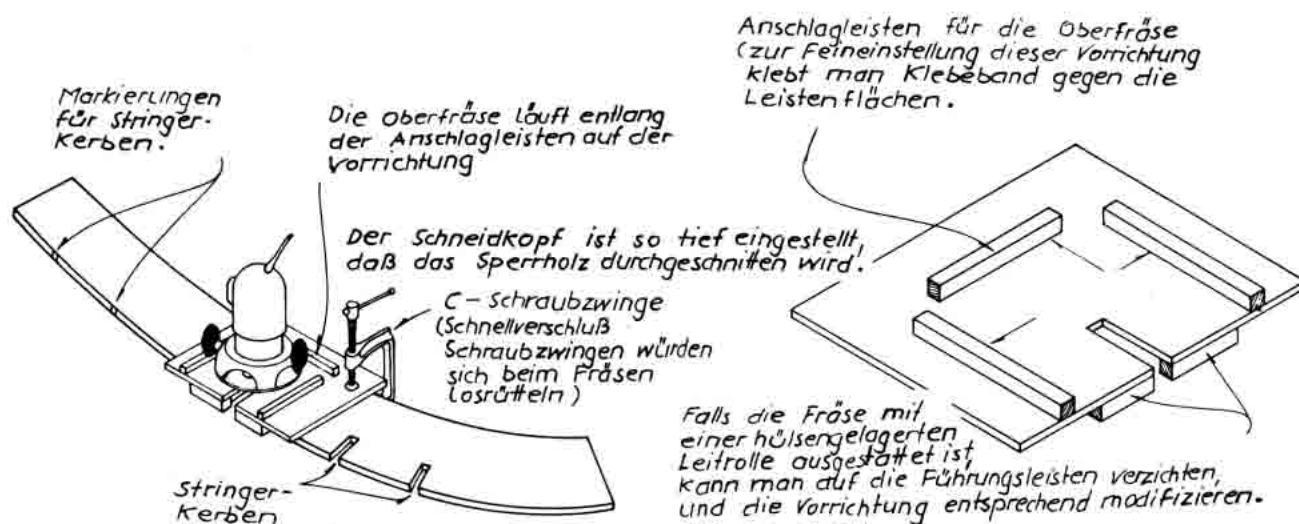
Bild 21.3 – Oberfräsenvorrichtung zum Kerben der Spanten und Decksbalken vor dem Aufstellen.
