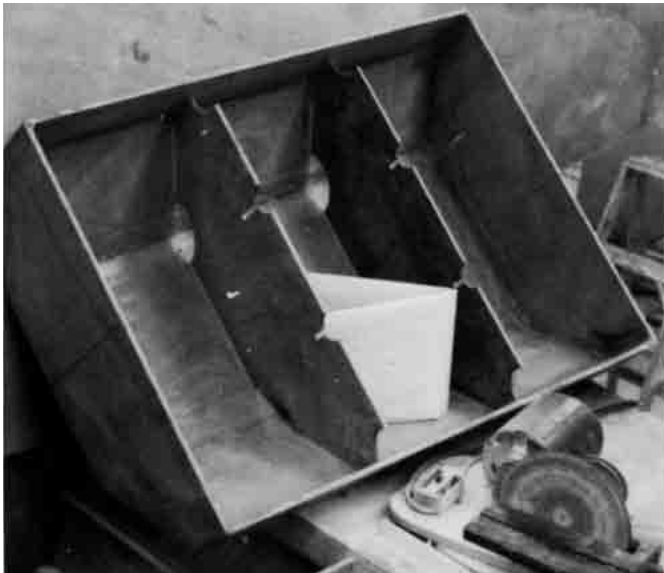
Bild 24.22 – 150-Liter-Tank der ROGUE WAVE, mit Hohlräumen und Glasfaserstreifen an allen inneren Verbindungen. Der Deckel dieses Tanks ist ein Teil des Kajütbodens; der Tank ist abnehmbar. Die Stege haben Ausschnitte an der oberen Kante, damit alle Abteilungen entlüftet werden. Die 10 mm-Einschnitte an den Unterseiten der Ausschnitte sind für Sperrholz-Längsspananten zur Stützung des Deckels vorgesehen.
