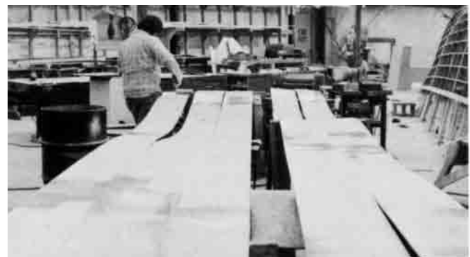
Bild 21.13 – Beschichtung von 12,20 x 0,30 m Paneelen aus Plankenholz. Das Schäften von Holz zu solchen Längen reduziert die Verschnitttrate.
