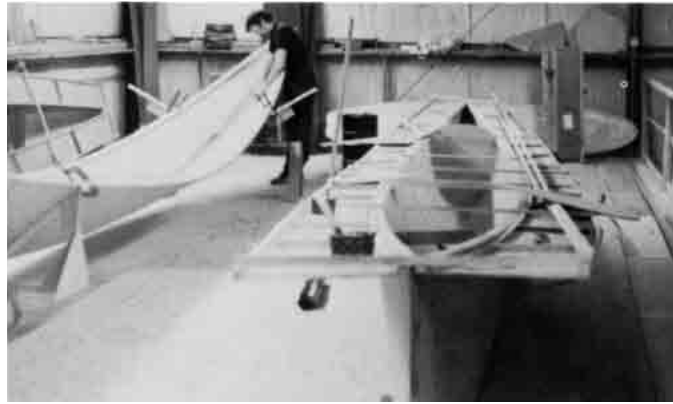
Bild 23.15 – Eingebogener Rumpf mit Decks-Einspannvorrichtung rechts. Links sieht man das Aufbringen der Glasfaserstreifen auf der Kiel-Hohlkehle von Sperrholzrumpfpfatten.
