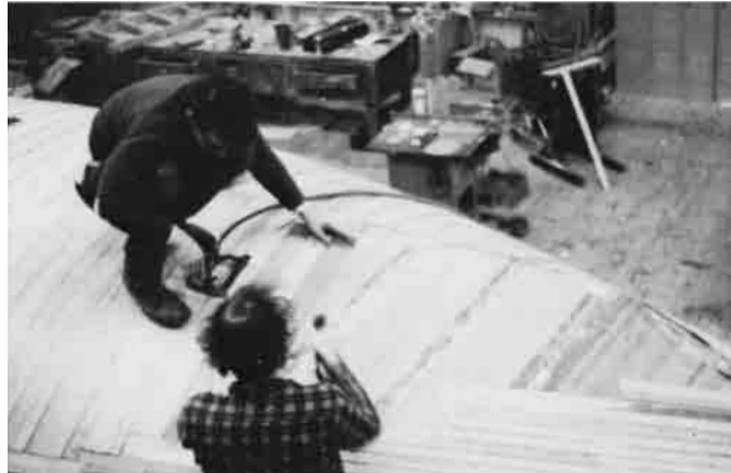
Bild 19.21 – Anbringen der letzten Furnierschicht auf dem Halbtonner GOLDEN DAZY. Die Seiten dieser Schicht wurden in Längsrichtung verlegt, der Unterwasserbereich quer zur Fahrtrichtung und wie im Bild gestoßen. Man beachte, daß die Furniere unter der letzten Lage viel breiter sind.
