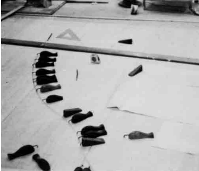
Bild 13.7 – Hier wird das Hinterschiff einer IOR-Rennyacht mit Strakgewichten und flexiblen Kunststoff-Latten aufgerissen.
