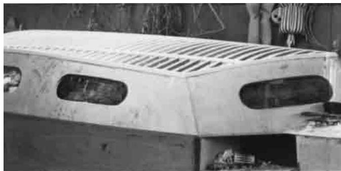
Bild 25.26 – Über der Kajüte und in der Kajüte befindlichen provisorischen Mallen gebautes Kajütdach. Kleine 12 mm breite mal 18 mm hohe Rippen wurden über der inneren Lage in 100 mm-Abständen von Mitte zu Mitte lamelliert und dann glatt gestrakt. Die Auffütterung für eine Vorsegel-Schiene wurde an der Kante der Kajüte eingefügt und dann eine 5 mm starke Lage auf das Dach geleimt.
