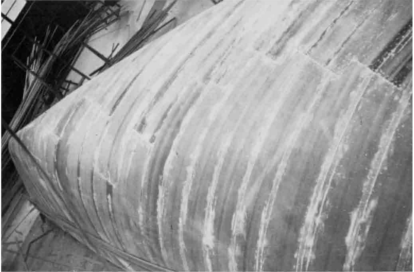
Bild 19.2 – Die Furniere der Zwischenlagen dieses lamellierten Rumpfes sind unregelmäßig gestoßen. Dies reduziert den Verschnitt und vereinfacht das Verlegen, ohne an Festigkeit im Rumpf einzubüßen. Beachten Sie die längs gelegte letzte Furnierschicht am unteren linken Bildrand.
