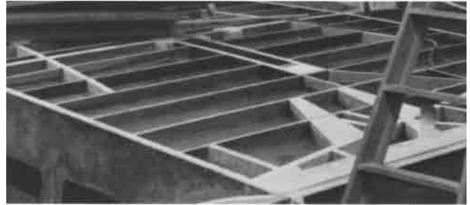
Bild 25.23 – Gesägte und mit dem Deckskeim und allen strukturellen Spanten verleimte Sitka Spmce Auffütterungen, mit dem Deck fluchtend beigehobelt. Man beachte den Auffütterungsstreifen für Genuaschiene am linken Bildrand.
