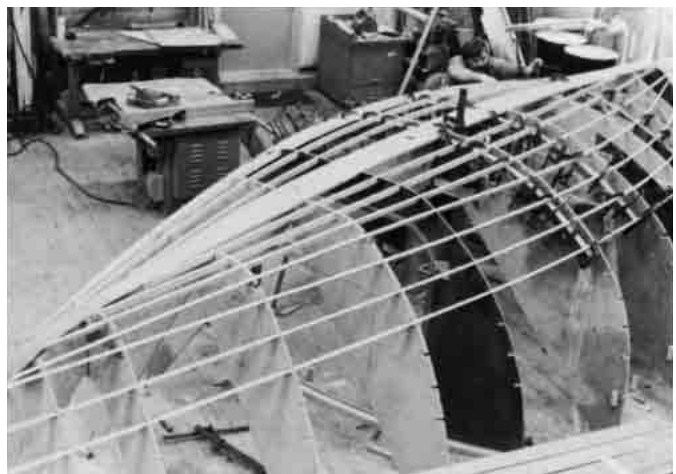
Bild 24.3 – IOR-Halbtonner-Rennyacht. In dieser Helling sind Schotten und Trennwände mit provisorischen Spanplatten-Mallen gemischt.
