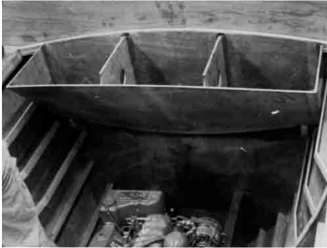
Bild 24.23 – Diesel-Kraftstofftank der ROGUE WAVE. Der Cockpitboden bildet den Deckel.
