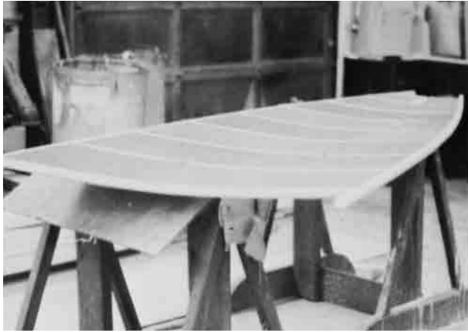
Bild 9.14 – Gekrümmter Plichtboden in Sandwichbauweise. Die Querleisten wurden dazu formverleimt, bevor sie mit den Deckschichten verklebt wurden.
