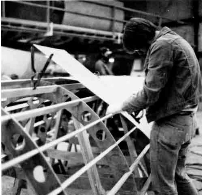
Bild 19.9 – Das Anpassen der ersten Lage Cedar-Furnier eines lamellierten Rumpfes. Die Planke ist in der Mitte gesichert. Dann werden die Enden justiert und an der Nachbarplanke angepaßt.
