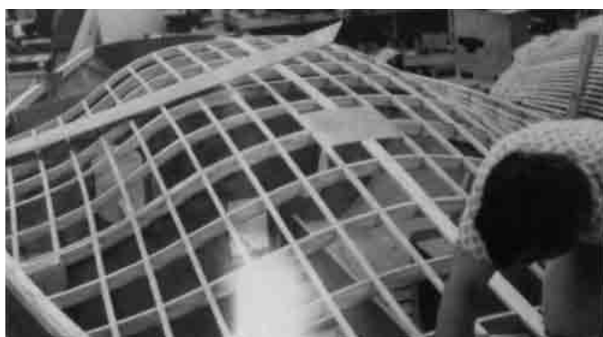
Bild 25.11 – Lamellierte Decksbalken und 25 x 18 mm-Stringer für ein Wulst-förmiges Deck einer Halbtonner-Rennyacht. Man beachte die spätere Mastdurchführung aus Sperrholz für den auf dem Kiel stehenden Mast.
