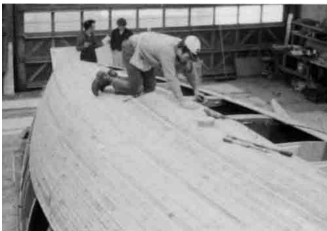
Bild 20.4 – Leistenbeplankung eines 12,83 m-Rumpfes. Diese Leisten werden von einer Hauptplanke an der Bilge bis zum Kiel verlegt.
