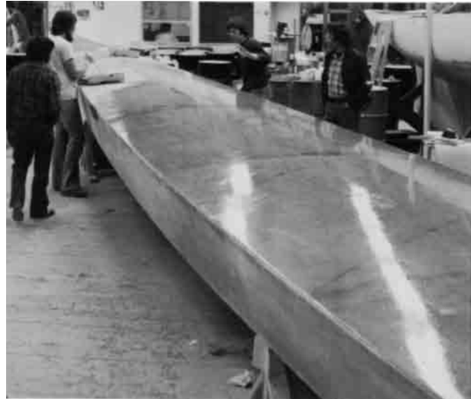
Bild 11.3 – Aufbau der Beschichtung auf dem Deck der Proa SLINGSHOT. Rumpf und Deck sind mit grau eingefärbtem Harz gestrichen.
