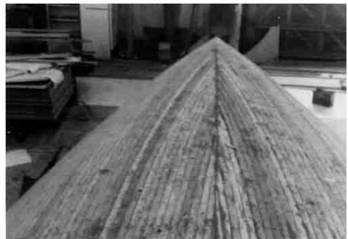
Bild 20.5 – Die Verbindungsnaht entlang des Kiels des in Bild 20.4 gezeigten 12,83 m-Rumpfes. Man beachte die Schraubenlöcher, wo die Planken am Block befestigt sind.
