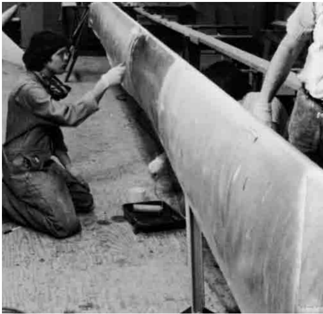
Bild 12.3 – Das Tränken eines Glaseidengewebes am Flügel-mast der Proa SLINGSHOT. Hierfür wurde ein Gewebe von 135 g/m 2 benutzt und mit der Rolle getränkt.
