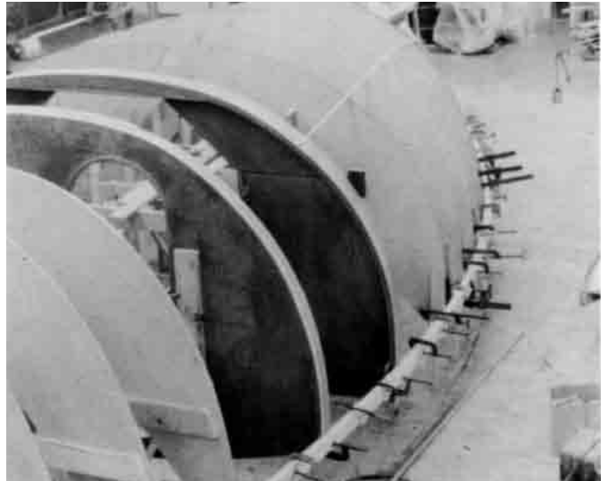
Bild 16.10 – Lamellieren des Balkwegers. Die Mallen sind noch nicht ausgeklinkt. Nach dem Aushärten wird der Balkweger abgenommen, nachgearbeitet und vorbeschichtet. Dann kann er in die Ausklinkungen eingelassen werden.
