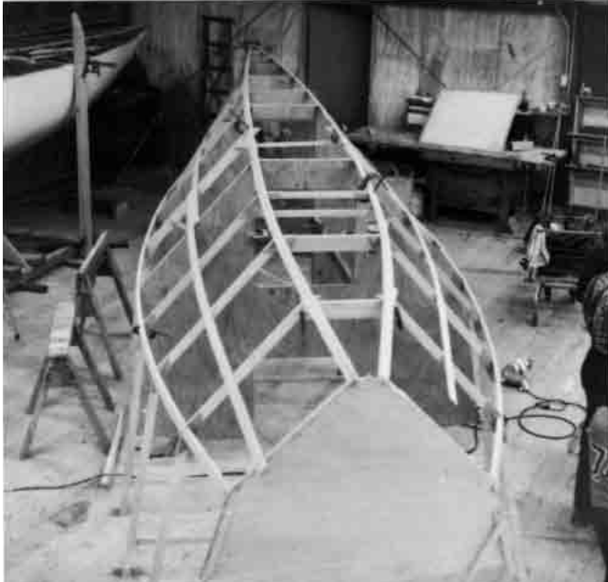
Bild 22.3 – Bei dieser Helling hat der Erbauer die Kimmweger eingebaut und strakt die Spanten.
