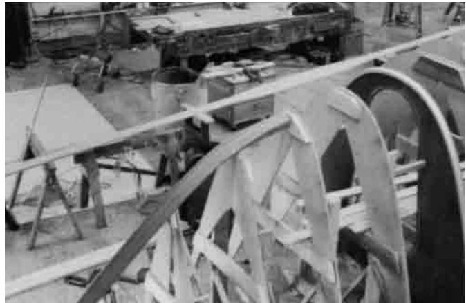
Bild 16.3 – Das Spantengerüst im Vorschiff der 12,8 m langen Segelyacht GOLDEN DAZY. Der Kiel liegt im Hintergrund auf Sägeböcken. Der nur schwach gekrümmte Boden dieser Yacht erlaubt es, den Kiel aus einem Massivholz zu fertigen.
