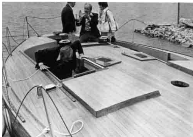
Bild 25.33 – Die Teak-Bepunktung des Decks der GOLDEN DAZY wurde parallel zur Mittellinie verlegt. Die Montage war dadurch viel einfacher, da die einzelnen Leisten nicht entsprechend der Krümmung der Seite Deck gebogen werden mußten. Dieses attraktive Muster erhielt viel positiven Zuspruch.
