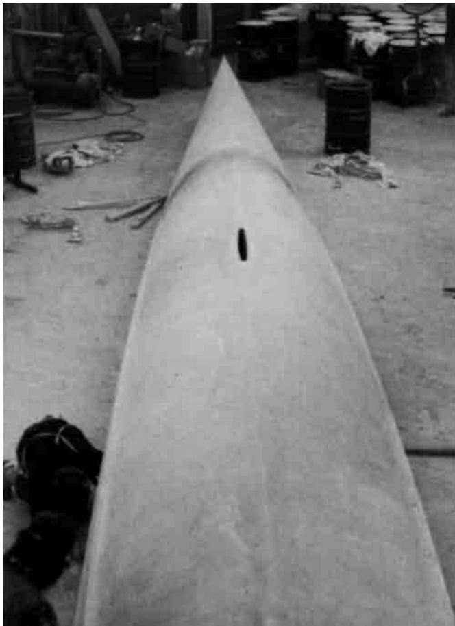
Bild 11.4 – Der Rumpfboden der SLINGSHOT wurde mit Harz beschichtet, dem Aluminium-Pigmente beigegeben wurden.
