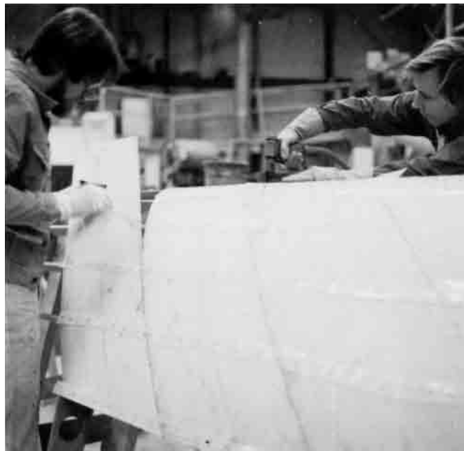
Bild 19.15 – Auftragen von Harz auf die Kante eines Cedar-Furniers.
