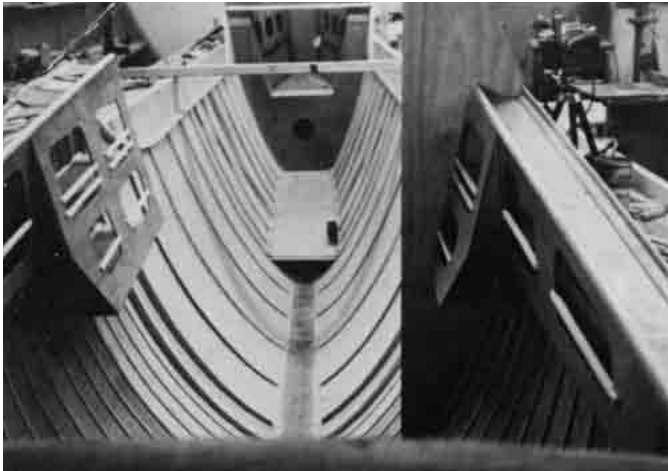
Bild 23.22 – Verschiedene Spanten, Schotte und Inneneinrichtung zur Stützung der Sperrholz-Außenhaut eines 10,70 m-Trimarans.
