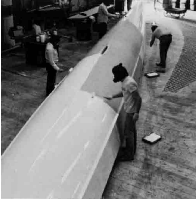
Bild 11.6 – Ein linearer Zweikomponenten-PU-Lack wird mit der RoDe aufgetragen.
