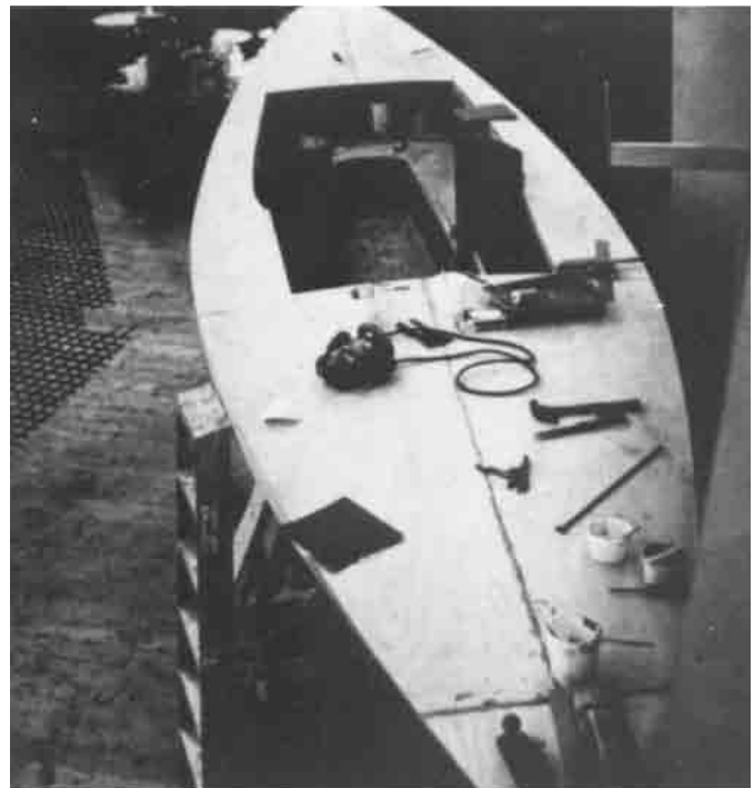
Bild 25.30 – LUDERS 16 Deck mit einer 6 mm dicken Schicht aus 5-lagigem Gabun-Sperrholz. Der Teakholz-Belag trägt zur Festigkeit und Steifigkeit bei.
