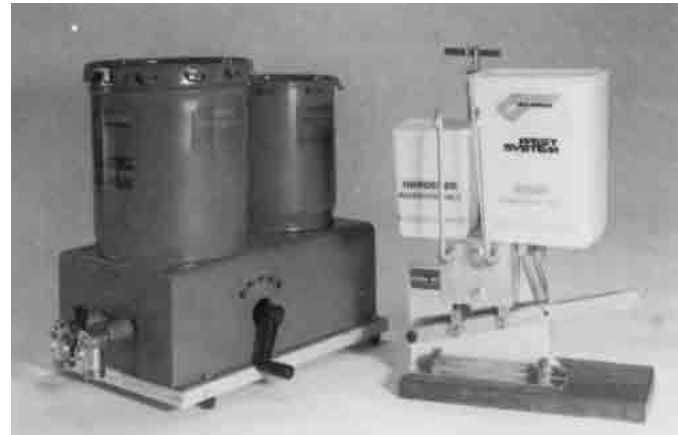
Bild 7.3 -Dosierpumpen: Links die Zahnradpumpe 309, rechts die Dosierpumpe 306 A.
