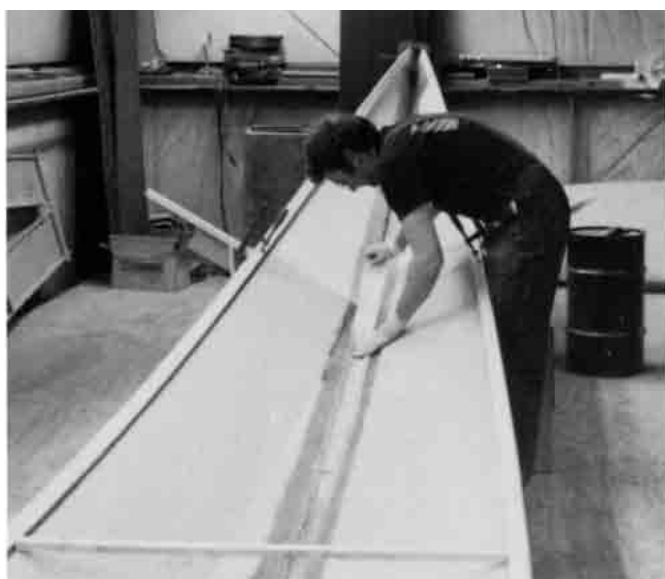
Bild 23.10 – Aufbringen von Glasfaserstreifen über Hohlkehle am Kiel eines 9,10 m-Rumpfes.
