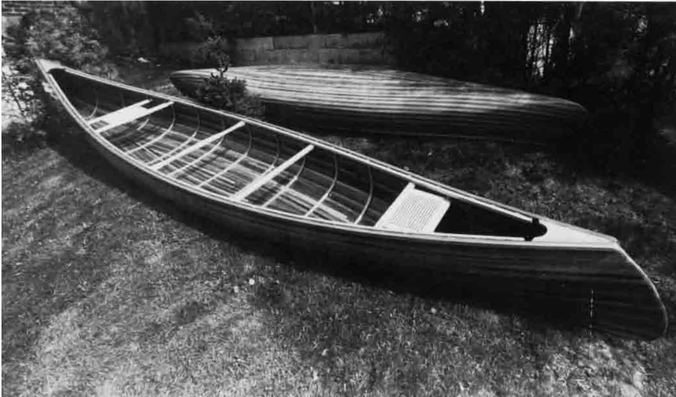
Bild 20.10 – Leistenkanus gebaut von Hersehel Payne. Western Red Cedar und WEST SYSTEM Epoxidharz wurden bei beiden Booten verwendet. Das 4,50 m-Modell wiegt 14,7 kg und das 5,40 m lange wiegt 22 kg.
