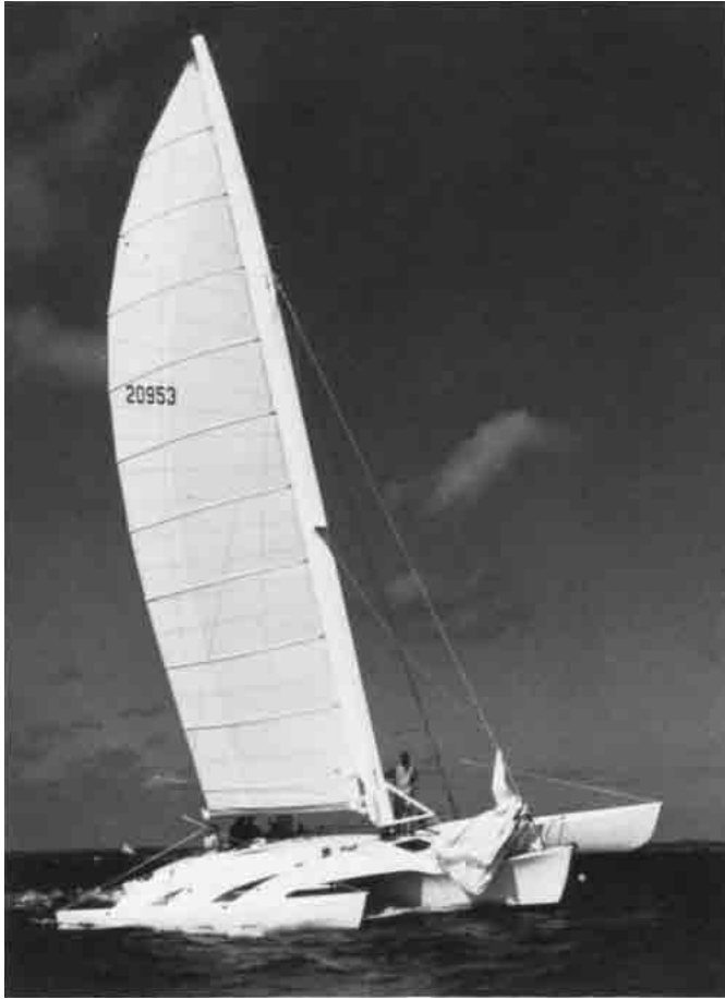
Bild 2.1 – ROGUE W AVE, ein seegehender Renn-Trimaran, den Dick Newick für den verstorbenen Phil Weid entworfen hat. Pläne sind vom Konstrukteur erhältlich. (Der Profdmast wurde von der Fa. GOUGEON BROTHERS Inc. entwickelt).
