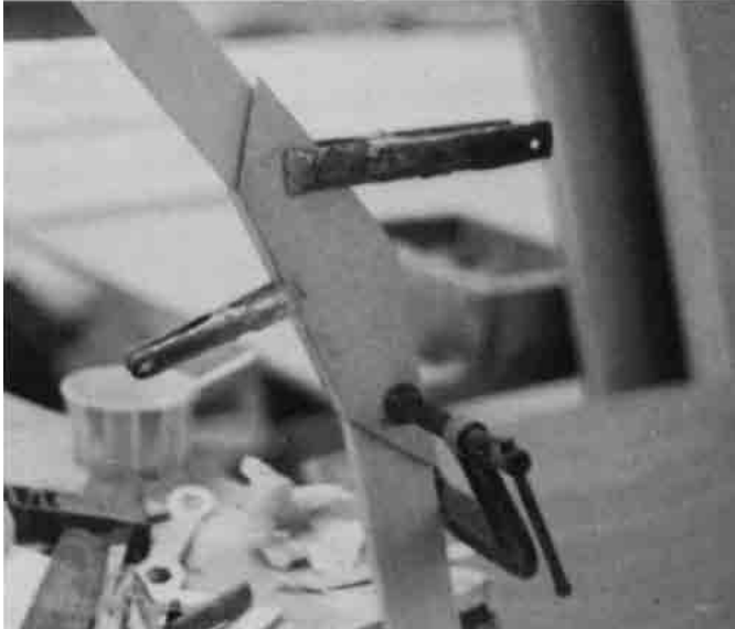
Bild 14.6 – Verleimen einer Dopplung an einen Bauspant.
