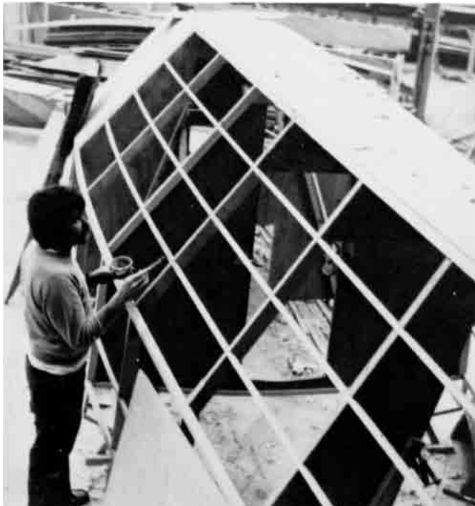
Bild 22.8 – Auftragen der Klebmischung vor dem Verleimen einer Platte mit dem Rahmenwerk. Die im Vordergrund liegende Platte wird auf dem Rumpf geschäftet.
