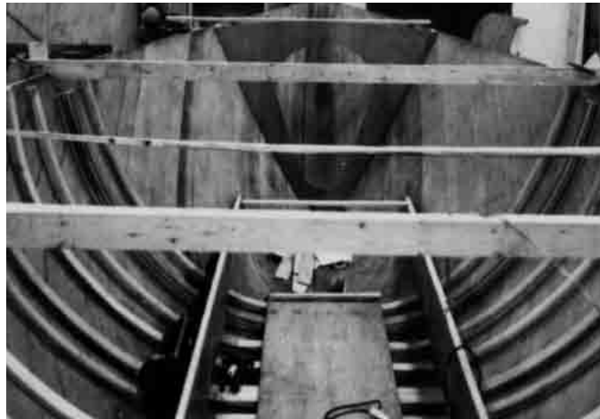
Bild 9.7 – Lamellierte Spanten, im Rumpf eingebaut.
