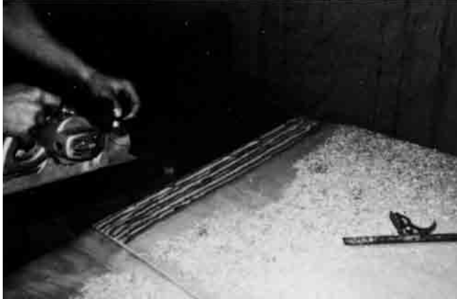
Bild 10.11 – Herstellen der Schäftungen an schmalen Sperrholzstreifen mit der Hobelmaschine.
