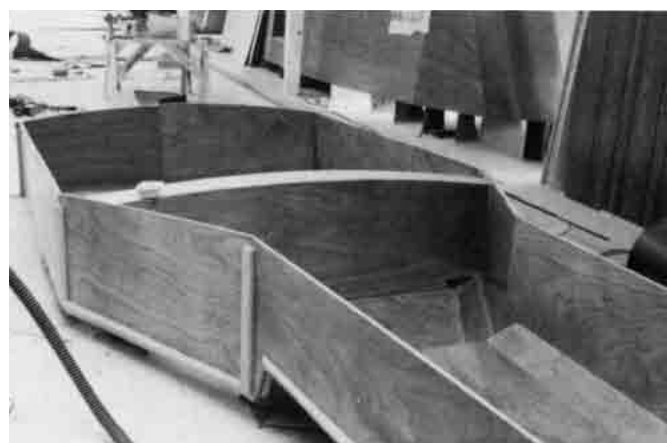
Bild 25.12 – Montiertes Cockpit, das außerhalb des Rumpfes gebaut wurde.
