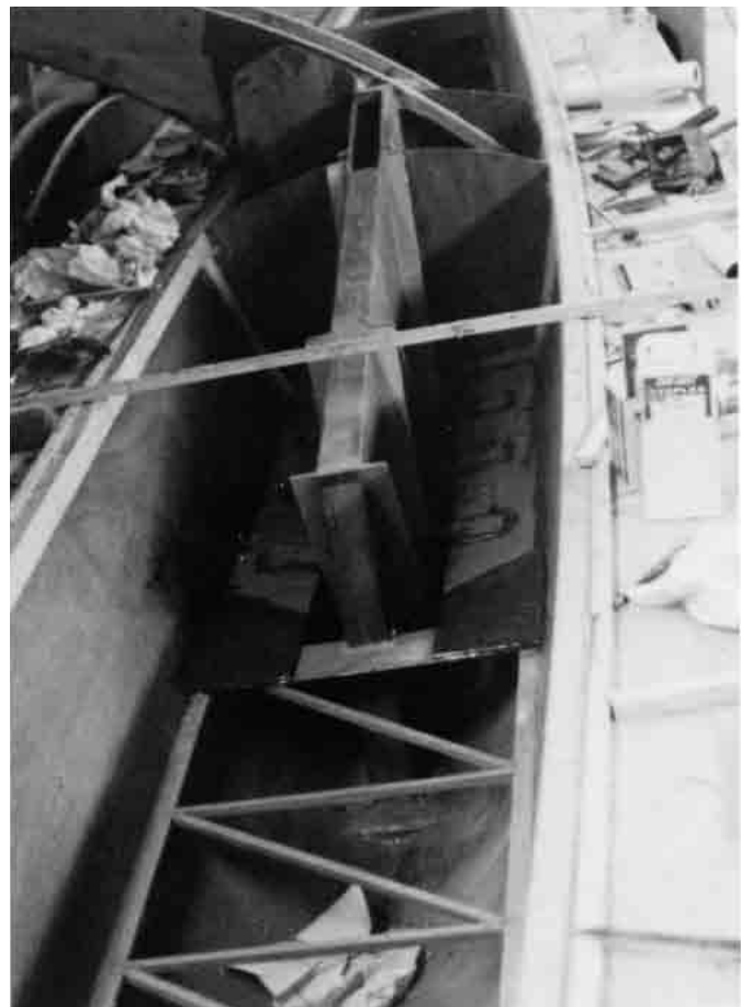
Bild 23.19 – Konstruktionselemente in einem 9,10 m-Trimaran-Ausleger. Beam-(Querträger-) Versteifung und Schwertkasten sind mit Schotte und Zwischenstringer verstrebt und gesichert.
