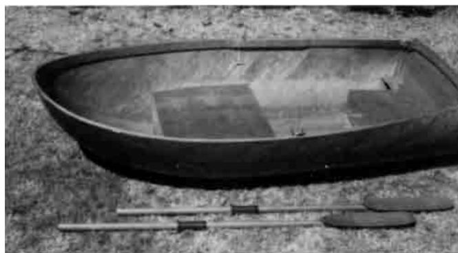
Bild 17.3 – Formverleimtes Dinghi, gebaut von Peter Unger. Diese Größe und dieser Stil sind ideal für die Block-Methode.
