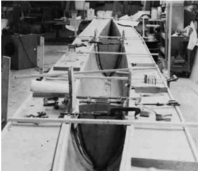
Bild 23.20 – Schotte verstärken die lamellierte Stelzen, mit denen die Beams verleimt werden.
