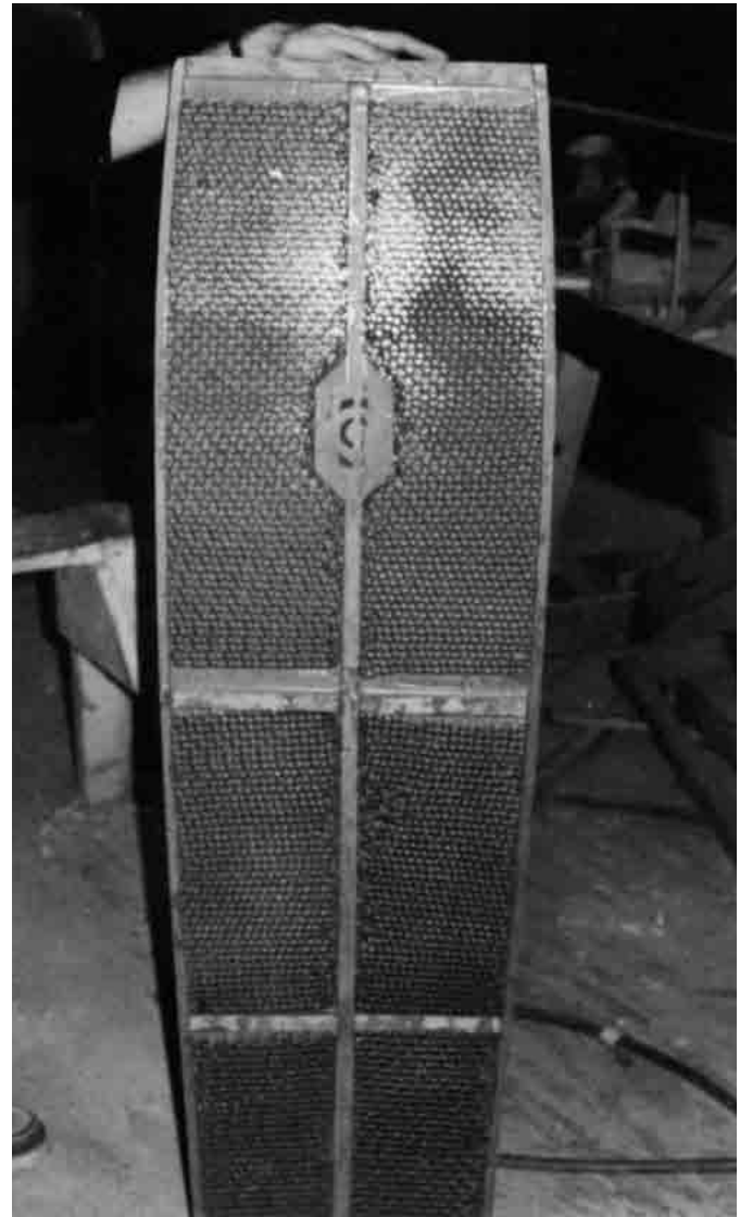
Bild 9.9 – Eisyacht der ON-Klasse. Der Boden zeigt Wabenkernmaterial, das von Leisten eingefäßt ist. Die Deckschicht ist noch nicht aufgebracht.
